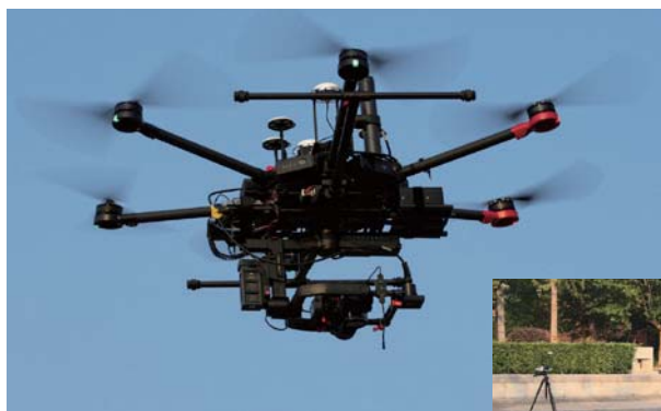
太阳光诱导叶绿素荧光无人机监测系统
