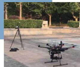
太阳光诱导叶绿素荧光无人机监测系统
